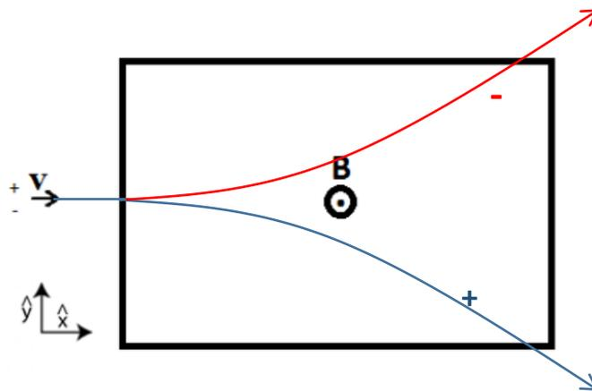
Pela regra da mão direita, a força sobre a carga positiva será para baixo, produzindo a trajetória azul desenhada acima. A força sobre a carga negativa será oposta, ou seja, para cima, produzindo a trajetória vermelha na figura.
