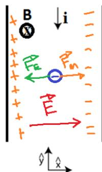
Na figura vemos que na situação de equilíbrio, os elétrons ficam à direita: a fita fica negativa à direita e positiva à esquerda, surgindo o campo elétrico  $\vec{E}$  que aponta para a direita. Como a força elétrica sobre os elétrons, portanto será para a esquerda, ficará equilibrada com a força magnética. Pensando para o caso de um único elétron teremos:
